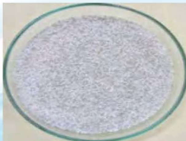
\text{Li}_2\text{TiO}_3 pebbles of 1 mm size
