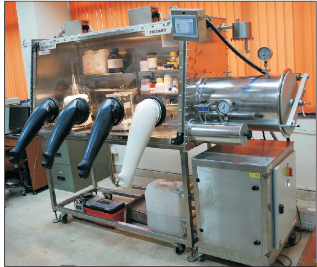
अक्रिय गैस ग्लॉब बॉक्स के भीतर स्थित विद्युत रासायनिक लवण शोधन प्रदर्शन सुविधा जहां ऑक्सीजन व नमी दोनों की ही मात्रा 1-1 ppm से नीचे रखी जाती है
