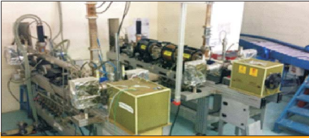
विकिरण प्रसंस्करण सुविधा पर स्थापित दो 10 MeV, 5 kW वाले रैखिक त्वरक
