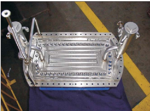
एनबीआई पीआईएनआई आयन स्रोत की बैक प्लेट का उच्च ताप प्रवाह परीक्षण
