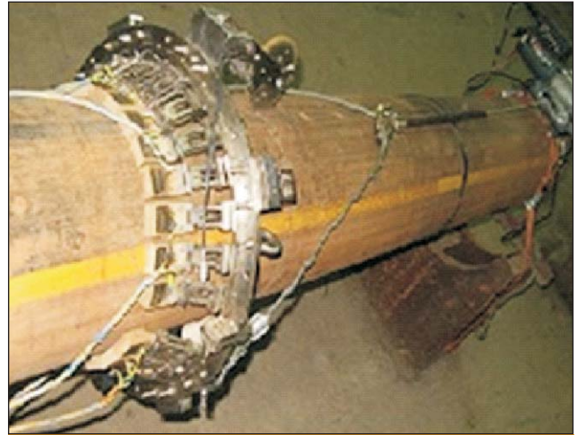
पाइप लाइन निरीक्षण गेज हेतु वलय-प्रकार की भंवर धारा आधारित निरीक्षण प्रणाली
