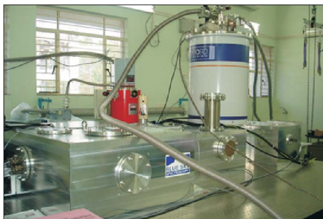
एफ.ई.एल. विकिरण के उपयोग के लिए आईआर-टेराहर्ट्ज आवृत्ति डोमेन स्पेक्ट्रोमीटर का सेट अप
