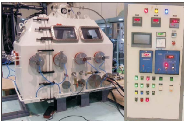
गुहिका ट्रेसिंग के लिए नियंत्रित वातावरण ग्लोव बॉक्स तथा इसकी नियंत्रण पैनल
