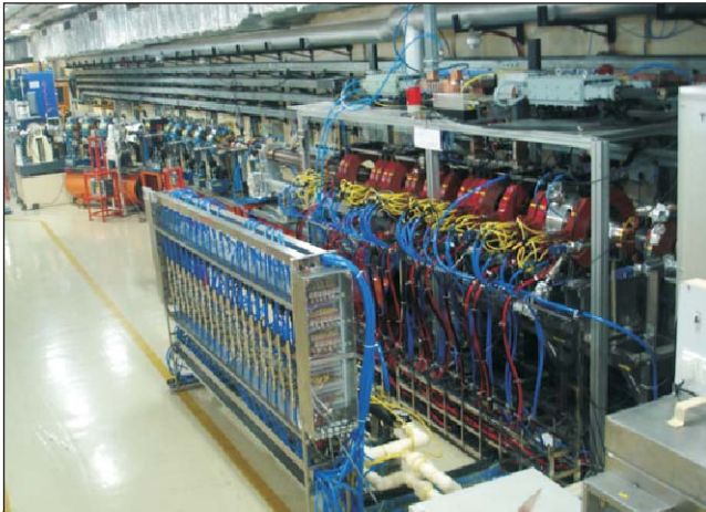
अवरक्त मुक्त इलेक्ट्रॉन लेजर सेटअप 60 मीटर लंबे विकिरण परिरक्षित क्षेत्र के अंदर स्थापित किया गया है
