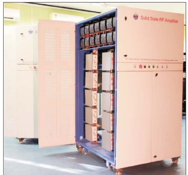
आरएफक्यू (RFQ) के लिये 100 kW, 325 MHz स्पन्दित टोस-अवस्था आरएफ प्रवर्धक
