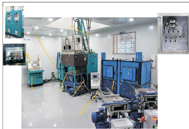
बीएआरएनएस द्वारा वित्तपोषित: आरआरकेट, पऊवि हेतु सीजीसीआरआई, कोलकाता में लगाया गया 15 L इंडक्शन फर्नेस
