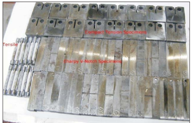
कुडनकुलम VVER रिएक्टर से ताप काल प्रभावन निगरानी नमूनों से यांत्रिक परीक्षण नमूनों के प्रकार
