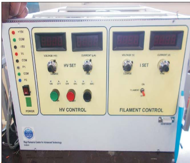
SEM के लिए संस्थान में विकसित उच्च वोल्टता शक्ति आपूर्ति का एक दृश्य
