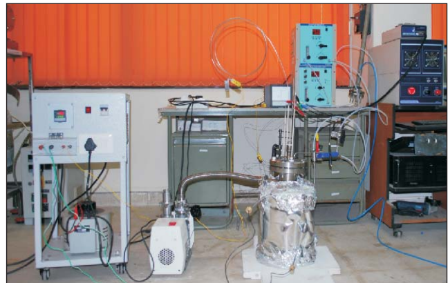
गलित फ्लोराइड लवणों में अशुद्धियों के ऑनलाइन मापन के प्रदर्शन हेतु सुविधा
