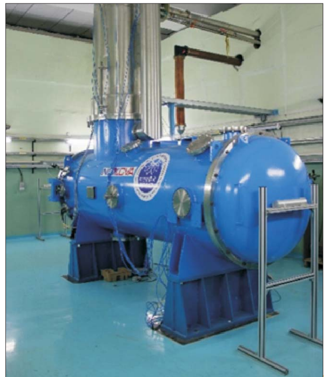
क्रायोजेनिक स्थानान्तरण लाइन के साथ क्षैतिज परीक्षण स्टैंड (HTS) क्रायोस्टैंट
