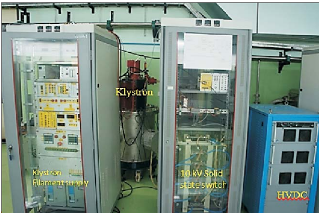
उच्च विभव टोस अवस्था स्विच का क्लायस्ट्रॉन के साथ परीक्षण सेट अप
