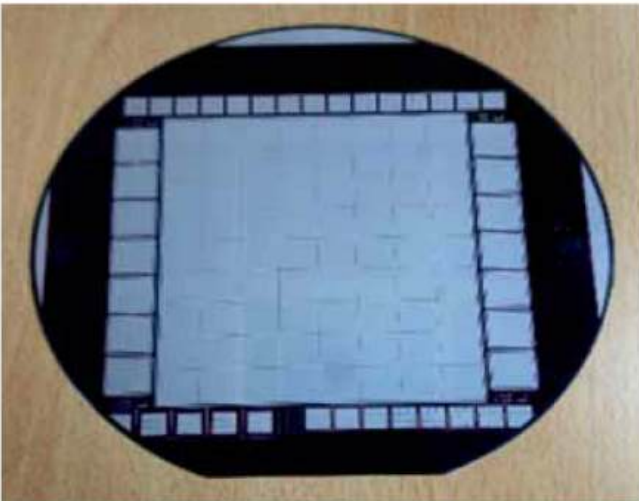
6-इंच Si वेफर पर p-प्रकार Si पैड क्रम-विन्यास संसूचक (केंद्र में) का चित्र
