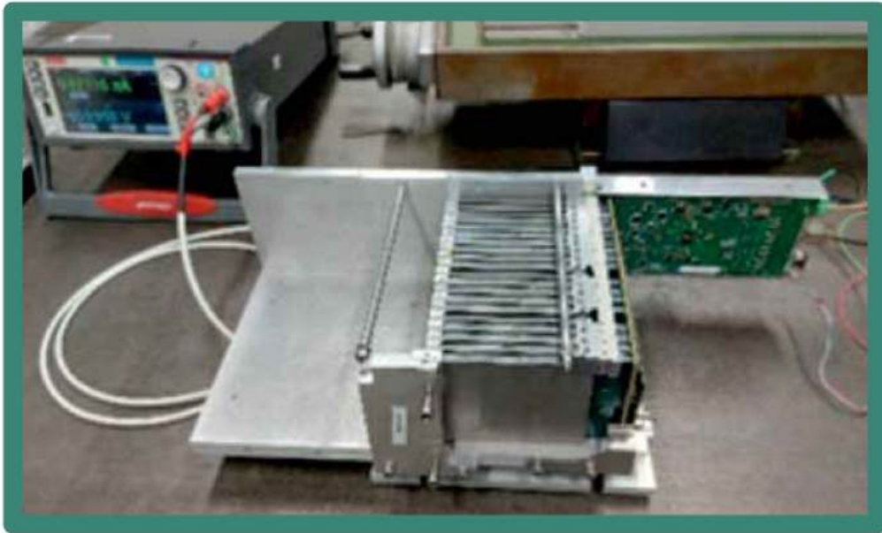
टंगस्टन प्लेटों से जुड़े n -टाइप Si संसूचकों की एक प्रोटोटाइप असेंबली
